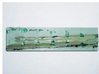
Abb. 6 Klotz nach schädlichen Wechselwirkungen
